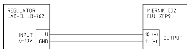
Rysunek 3.3: Schemat podłączenia miernika typu FUJI ZFP9
